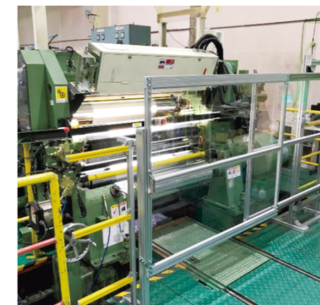
生産設備への全面カバー設置による侵入防止策
