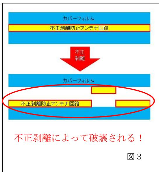
このように、アンテナ回路を破壊させずにカバーフィルムを剥がす、商品からRFIDを剥離するといった行為が困難になり、
