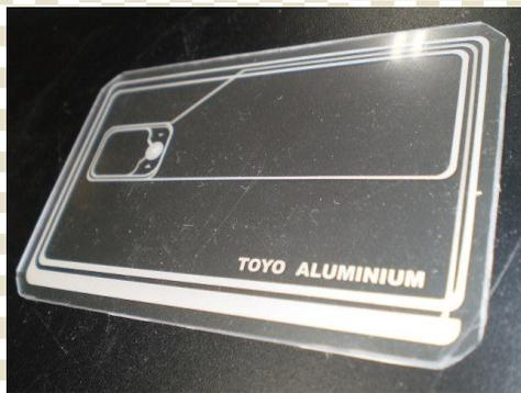
アルミエッチングアンテナ回路
