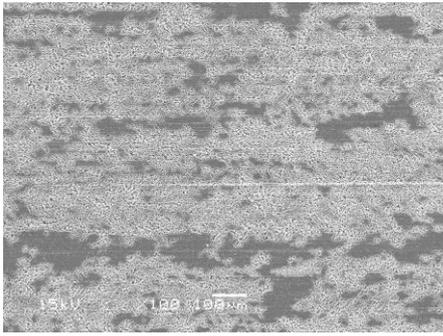
图2 经过化学性处理的铝箔表面
