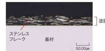
ステンレスフレーク入り塗料の塗膜断面写真
