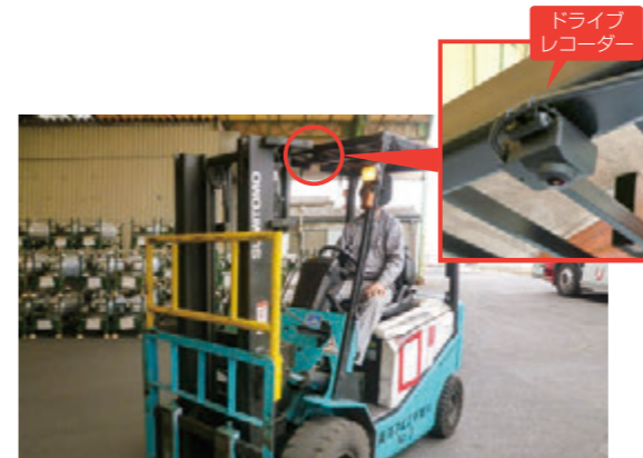
ドライブレコーダー設置
