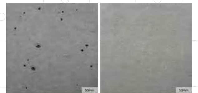
コンクリート表面写真／従来(左)、アート型枠®使用(右)
