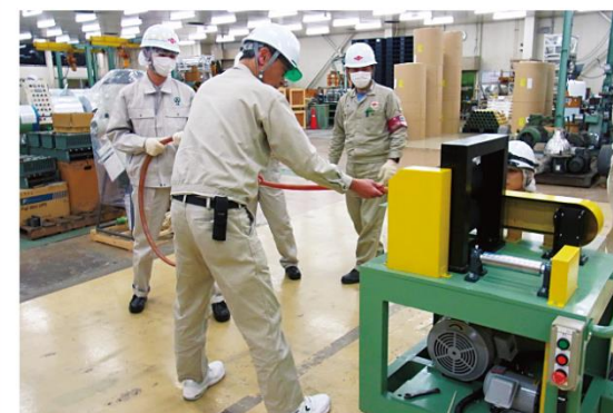
橡胶软管卷入运行辊筒的实验
