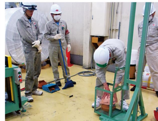
有无头盔的坠落冲击实验
