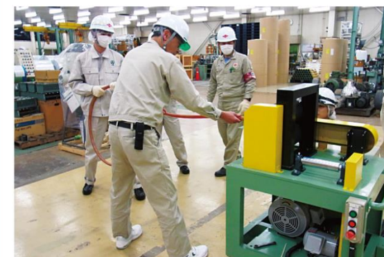
橡胶软管卷入运行辊筒的实验
