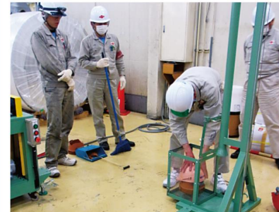
有无头盔的坠落冲击实验
