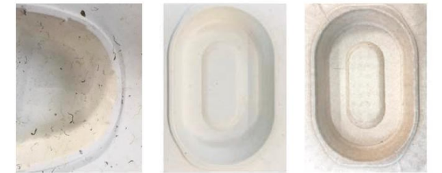
试制品 1 将产生的纸屑进行粉碎，通过分离工序分离树脂和纸浆然后成型 试制品 2 用过滤器去除细小树脂的模型 试制品 3 为弥补回收利用纸浆强度不足的缺点，通过混入原浆增强强度
