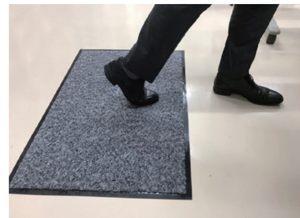
人が通過時に発生した電気をういてパソコンへ無線通信するセンサー
