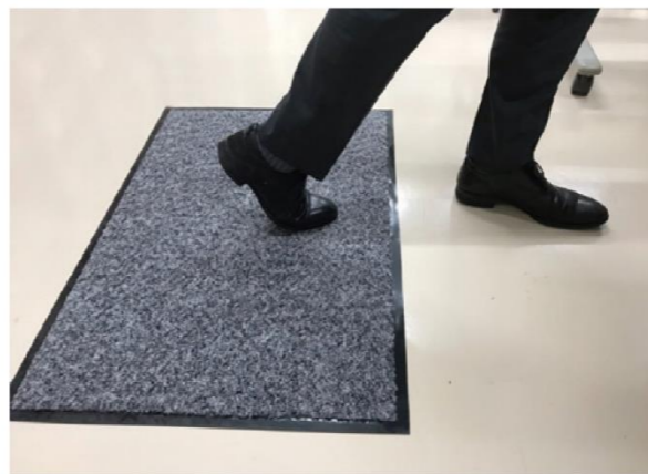
利用人通过时产生的电对电脑进行无线通信的传感器
