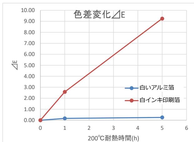
\* 白インキ印刷箔・・・アルミ箔(1N30)ツヤ面に白印刷
