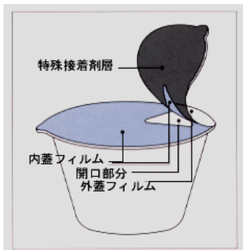
図1：P.O.TOPの構造例
