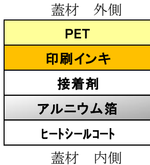
図2：ポーション用蓋材の断面図
