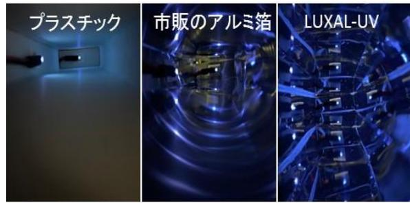
図3：ケース内の素材別UV-C照射状態
