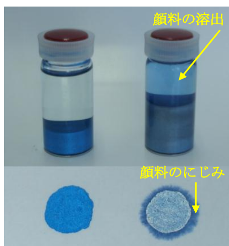
図3 着色アルミペースト(左)とアルミペーストと有機顔料の混合物(右)の比較 (上：有機溶剤に分散し、沈降させた状態、下：分散液を吸水紙に滴下した状態)
