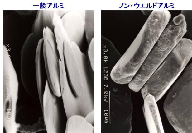
図2. 一般アルミとノン・ウエルドアルミの粒子厚み比較
