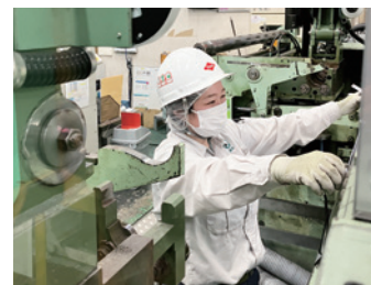
裁断機で製品コイルの幅を測定する瀧浪さん
