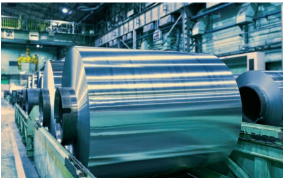
リチウムイオン電池の外装材に用いられるアルミ箔
