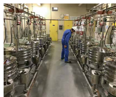
アルミニウム顔料の粉碎工程後に行われる、ふるい分け(スクリーン)工程の様子。
